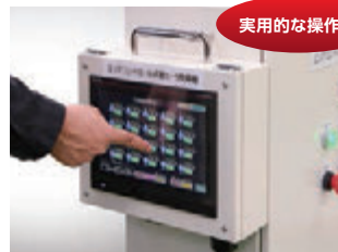
タッチパネルは制御盤から取り外して使用可能
